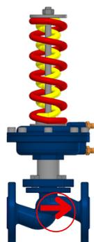
Обеспечить совпадение направления стрелки-указателя на корпусе с направлением потока рабочей среды.
